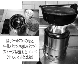
キャンプストープ 段ボール70gで米一合炊飯中
